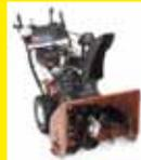
Cub Cadet 528 SWE (4-Takt, 357 cm<sup>3</sup>, 71 cm Breite, Einzugs Höhe 53 cm, Elektrostart, Fahrstufen: 6V/2R) um € 1.500,-
